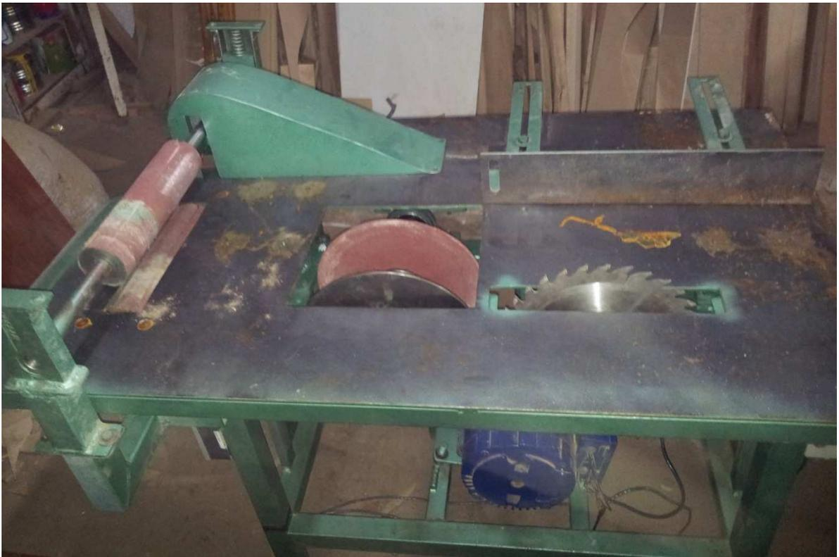
**Foto 6.5** Montaje del sistema de lijado plano superior.
