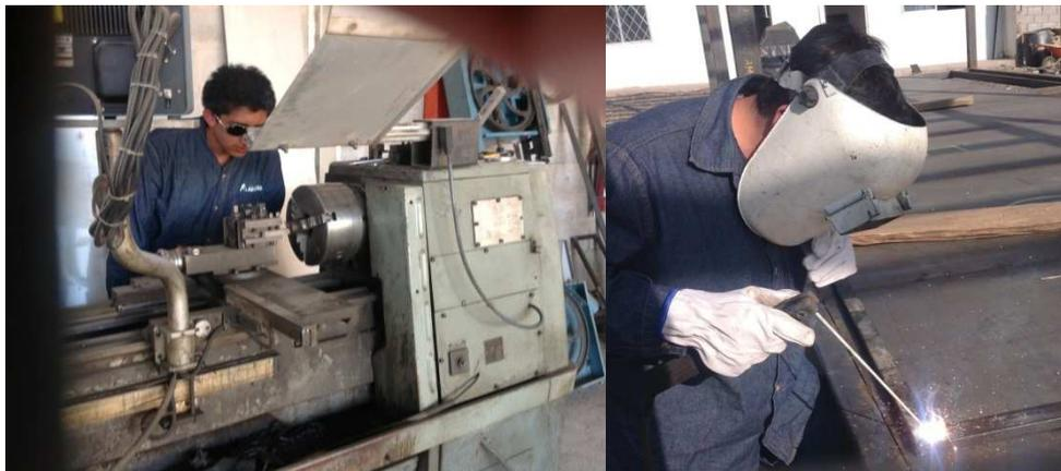
**Foto 6.2** Refrentado, cilindrado, roscado y soldadura
