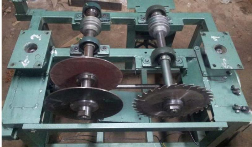
**Foto 6.4** Montaje del sistema de lijado de cantos
