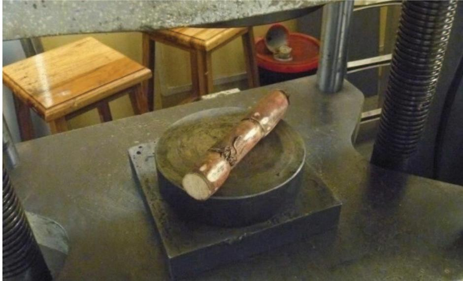
Fotografía 1.8 Colocación de la muestra para realizar el ensayo de aplastamiento
