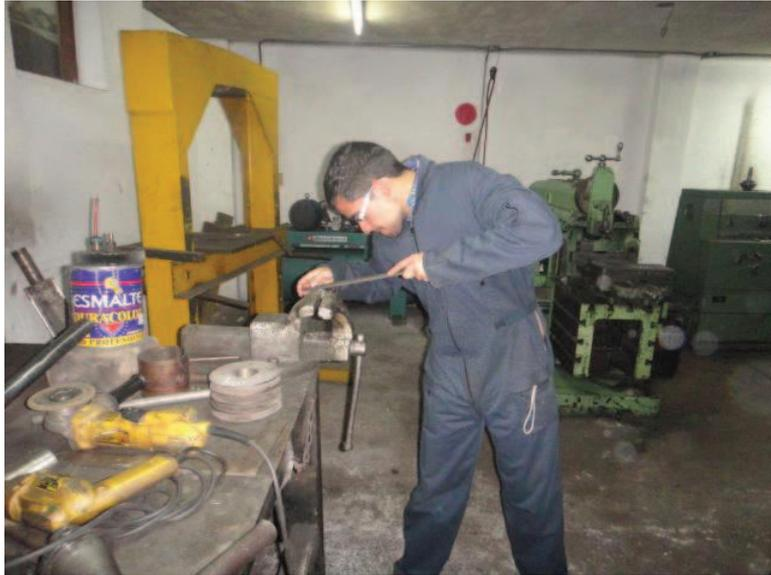
Fotografía 4.2 Operación de limado de la chaveta de talón.<sup>101</sup>
