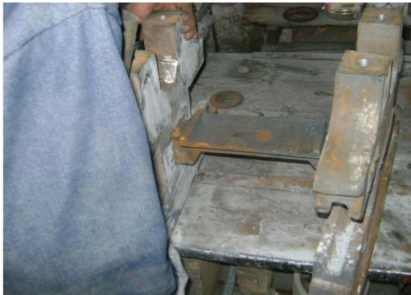
Fotografía 4.6 Montaje del Tornabagazo en los bastidores<sup>106</sup>.
