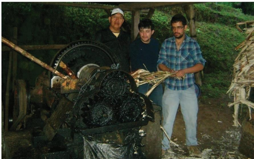
Fotografía 1.2 Extractora de jugo de caña horizontal accionada mediante una turbina Pelton en la parroquia Pucayacu provincia de Cotopaxi<sup>16</sup>.
