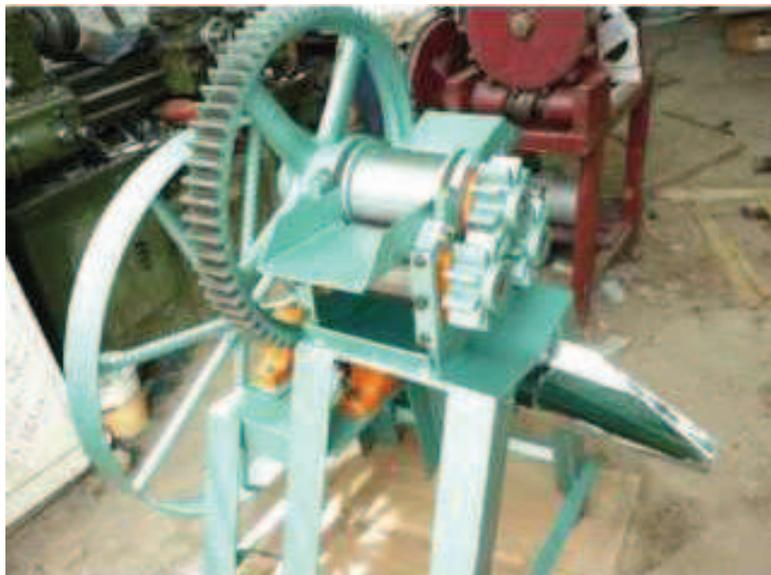
Figura 1.1 Molino o extractor de jugo de caña de rodillos horizontales.<sup>10</sup>
