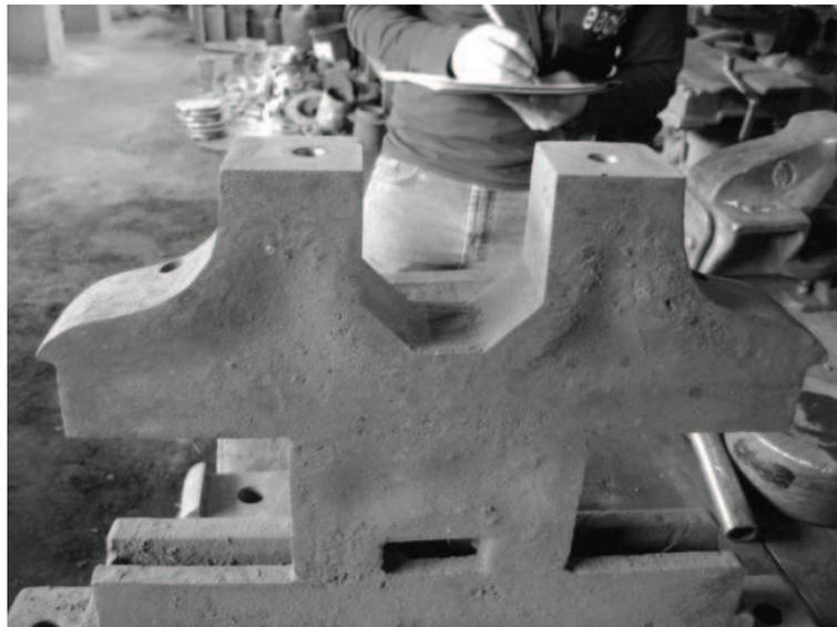
Fotografía 4.5 Bastidor o castillo- Vista trasera.<sup>104</sup>
