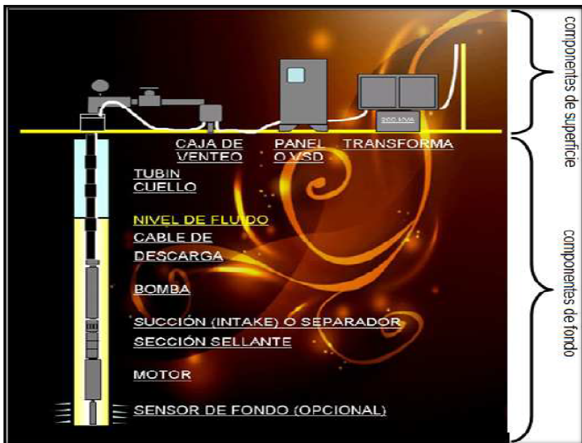
FIGURA 2. 5: COMPONENTES DEL BOMBEO ELECTROSUMERGIBLE
