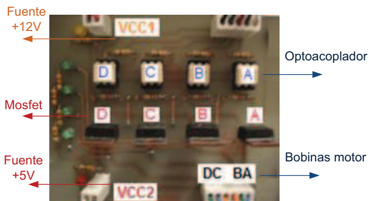
Figura 4. 5 Circuito de manejo motor paso a paso
