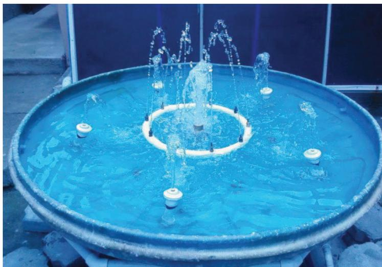
**Figura 4.6** Trabajo de fuente con 3 bombas de 1/2 HP
