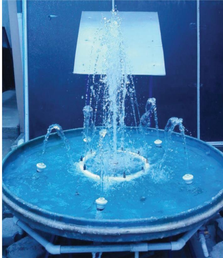
**Figura 4.7** Fuente funcionando con las tres bombas en arreglo final.
