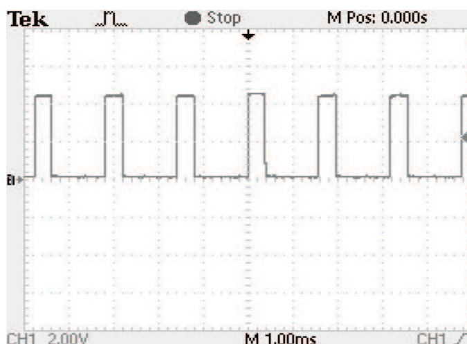
Figura 4.6. Forma de onda de los pulsos del encoder.
