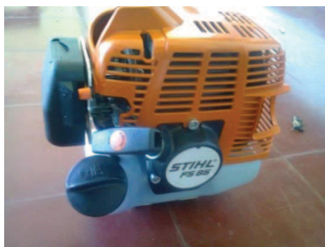
Figura 2.2. Motor de motoguadaña STIHL FS85.
