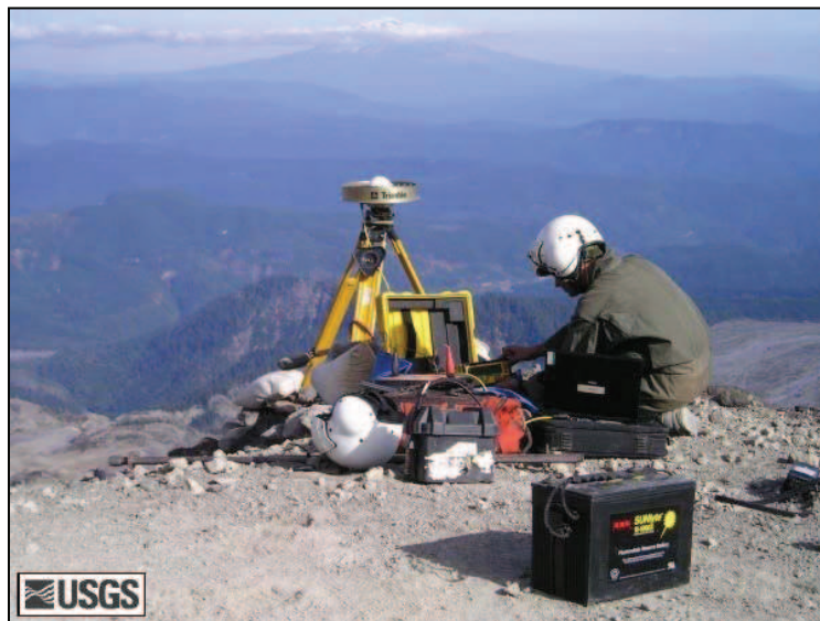
Gráfico 2. Trabajos de Mantenimiento en Estación GPS.
