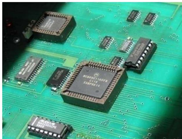
**Figura 1.19: Microcontrolador Motorola 68HC11 y chips de soporte**
