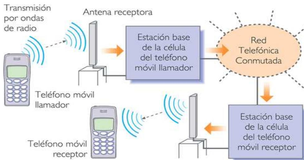
**Figura 2.3: Esquema de una red telefónica conmutada**
