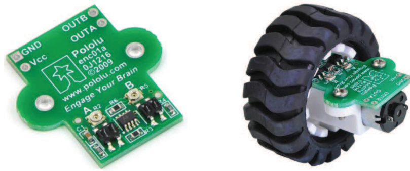
Figura 2.9 Izquierda) Encoder de cuadratura, derecha) Encoder de cuadratura, rueda todo terreno, micromotor y soporte.[19]
