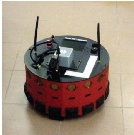
Figura 1.16 Robot móvil autónomo con sistema de sonares[5]
