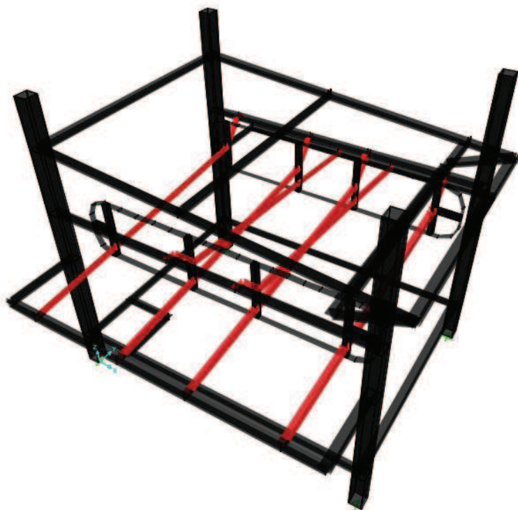
Figura 4.55 Perfil en L 30 x 30 x 3 [mm] (color rojo).
