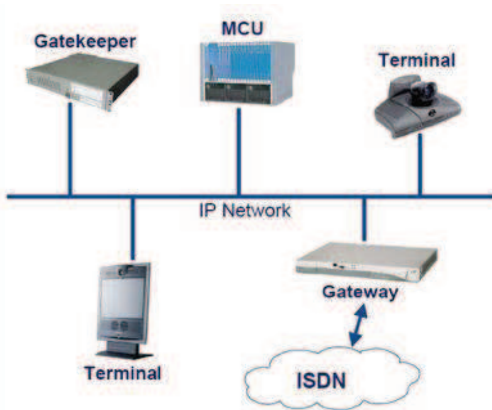
Figura 1.12: Estructura de red H.323 [PW13]
