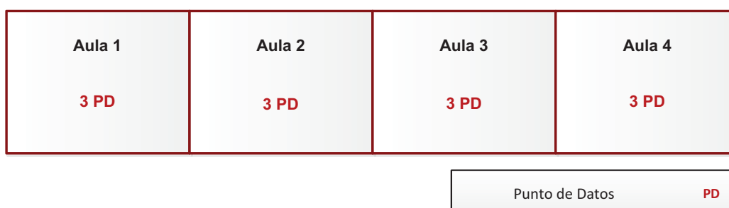
Figura 3.1: Esquema de distribución de los puntos de red en el Bloque A–Planta Baja
