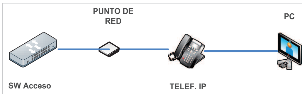
Figura 3. 20 Conexión PC y Teléfono IP a un Punto de Red
