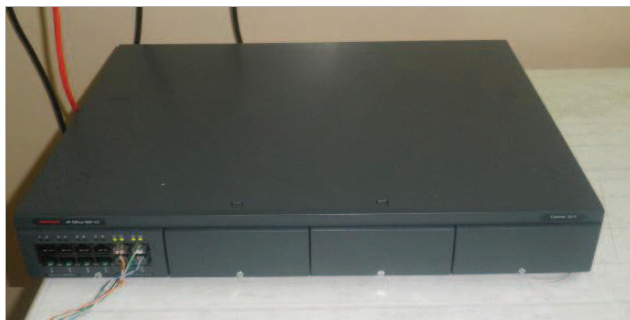
Figura 3. 21 Central Telefónica IP AVAYA IP Office 500 v2
