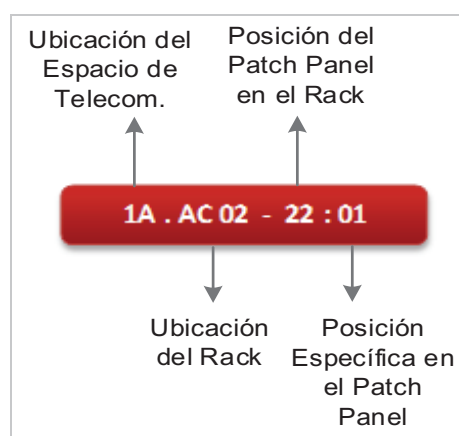
Figura 3. 15 Etiqueta Salida de Telecomunicaciones en el Faceplate (Telefonía)
