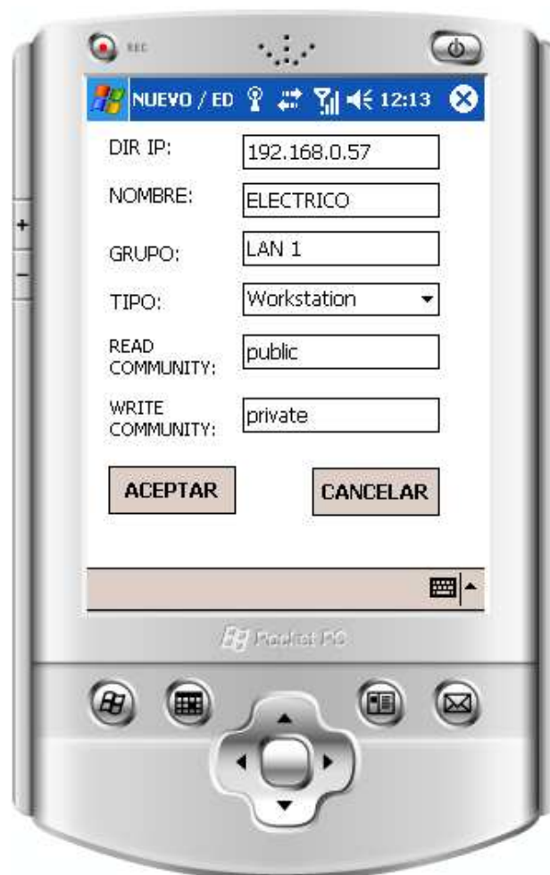
Figura 3.3 Ventana para Agregar Dispositivos
