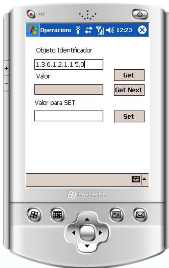
Figura C.11 Ventana Operaciones SNMP
