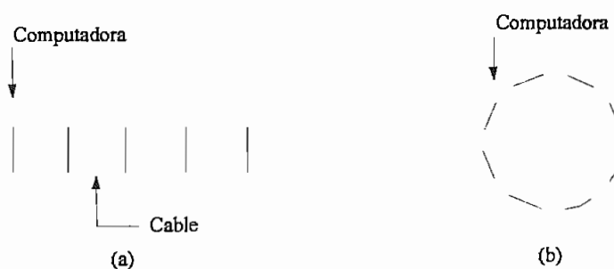
Fig. 2-13 Redes de difusión (a) Bus, (b) Anillo
