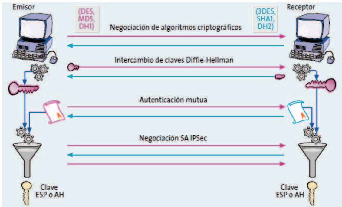
Figura 1.13 Funcionamiento del protocolo IKE [PW7]
