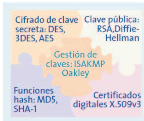
Figura 1.7 Tecnologías utilizadas en IPSec [PW7]
