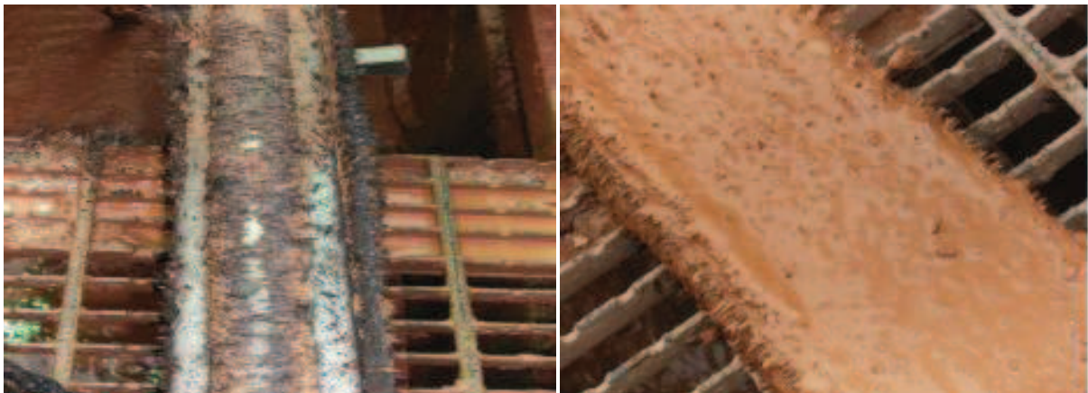
Figura 3.15: Magneto usado antes y después de la recolección de limallas Fuente: IPM - Schlumberger
