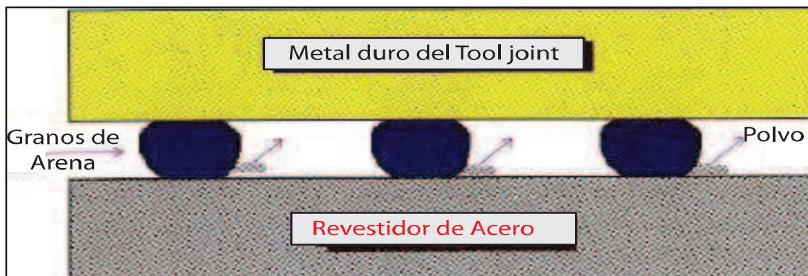
Figura 2.17: Mecanismo de desgaste por grinding
