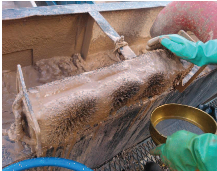
Figura 3.16: Limallas recolectadas por el uso del magneto en la etapa de perforación
