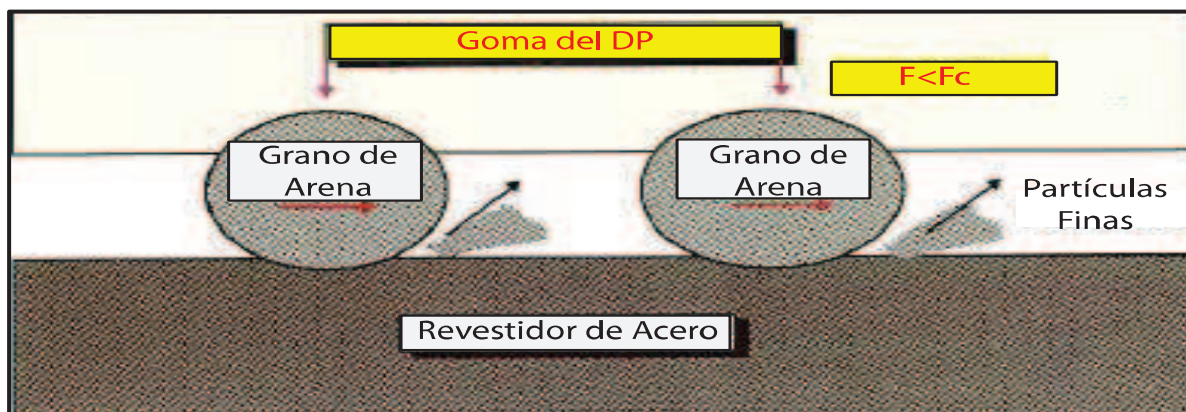
Figura 2.16: Mecanismo de desgaste por pulimiento
