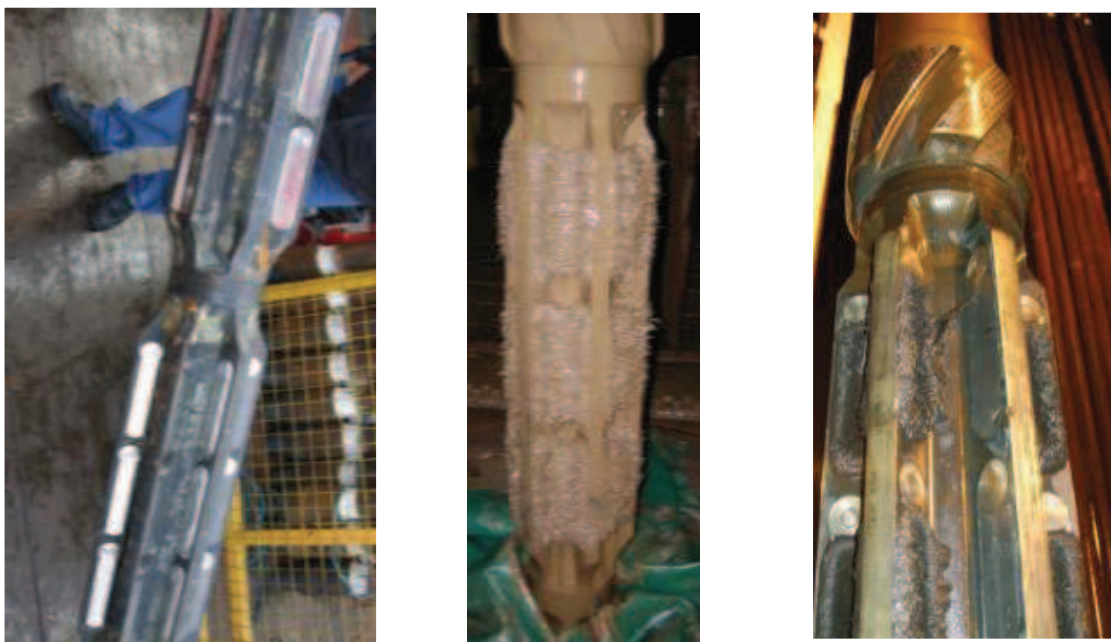
Figura 4.50: Magnostar , herramienta especializada en recolección de limallas en la etapa de completación
