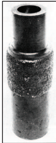
Figura 2.8: Banda de protección dura con granos de tungsteno (coarse-crushed) Fuente: Casing Wear Caused by Tooljoint Hardfacing - Bruno Best, 1985
