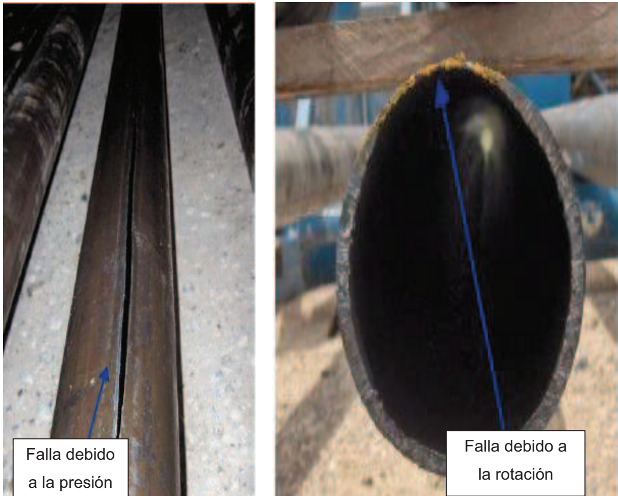
Figura 1.12: Desgaste del revestidor de 9 5/8" Fuente: Schlumberger – Proyecto Burgos IV IPM
