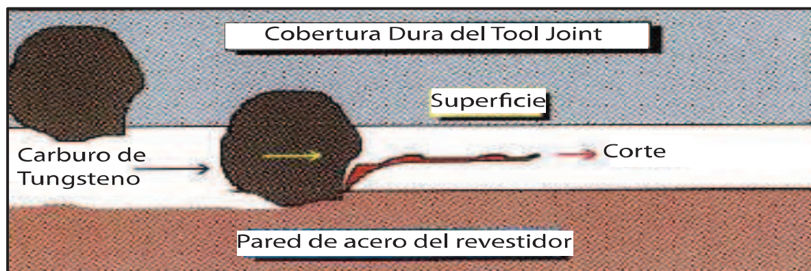
Figura 2.15: Mecanismo de desgaste por corte mecánico
