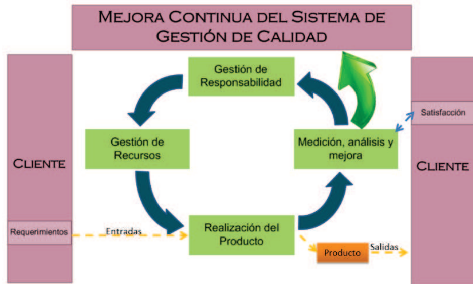
Figura 3. Modelo de un proceso basado en un Sistema de Gestión de Calidad (Norma ISO 9001)
