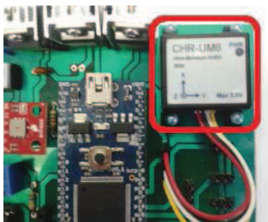
Figura 2.38 Ubicación de la IMU en la placa de adquisición y procesamiento de señales
