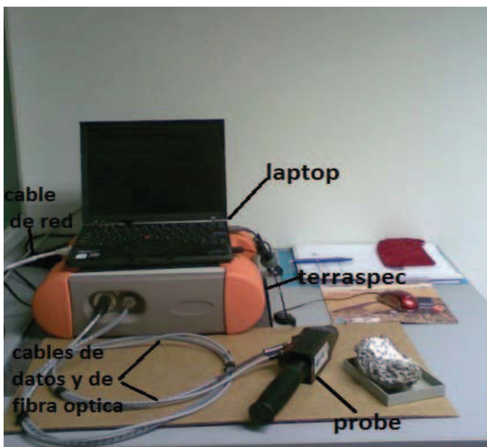
Foto 4.1 Equipo TerraSpec ensamblado con todos los elementos que lo componen (modificado de http://www.petrology.de/geraete ).
