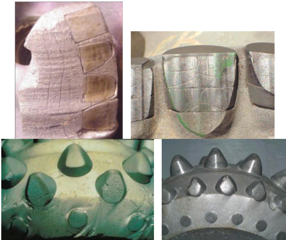
ANEXO 4. 17: Sobrecaentamiento (HC)
