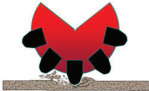
Figura 2. 2.- Acción del cono sobre la formación
