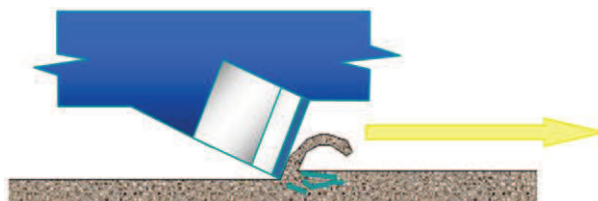
Figura 2. 8.- Acción del PDC sobre la Formación
