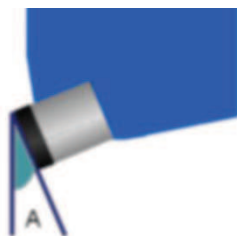
Figura 2. 10.- Angulo de inclinación del respaldo
