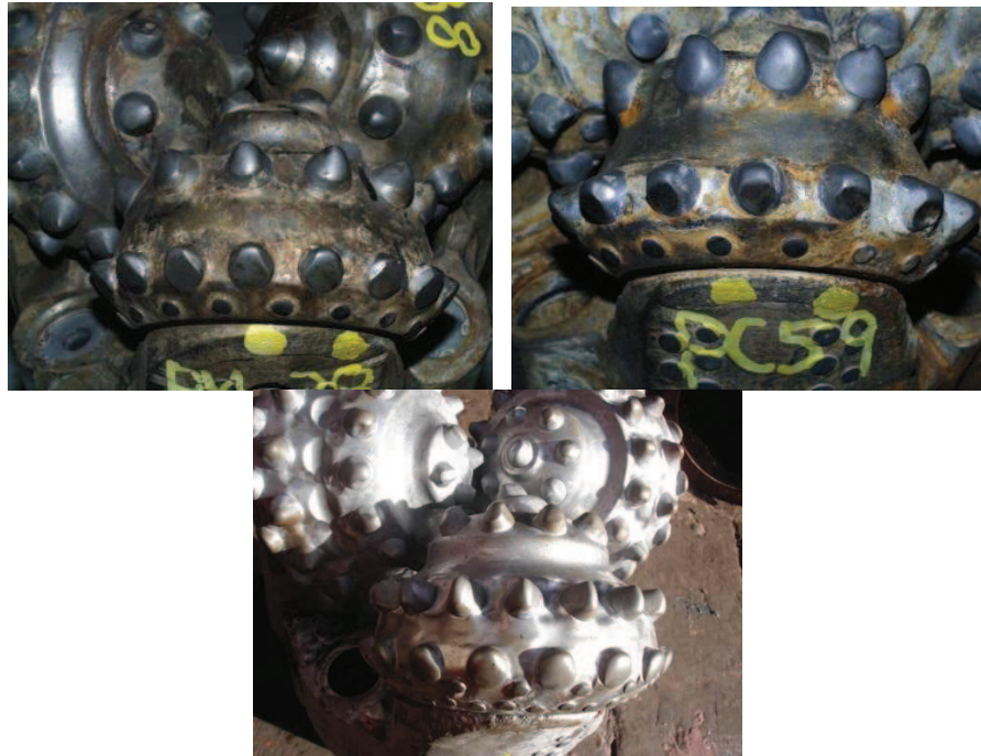
ANEXO 4. 26: Daño de Pata (SD)
