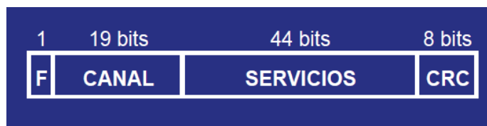
Figura 2-3 Estructura de la Trama que se transporta en el FAC 17
