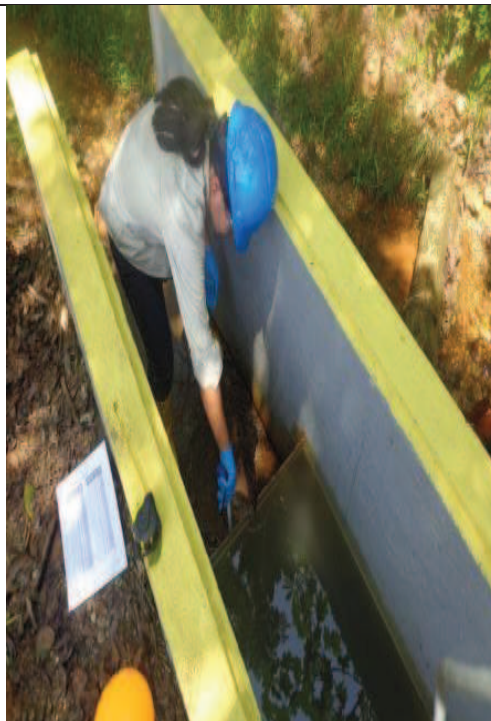
Foto No. 8.- Medida del caudal de descarga del campamento SPF – Bloque 16
