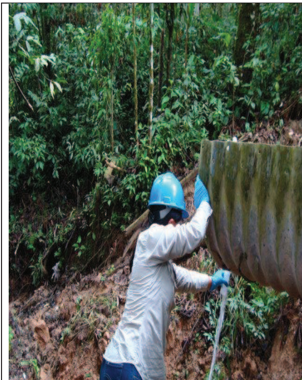
Foto No. 9.- Toma de muestra de descarga de aguas industriales – Bloque 16
