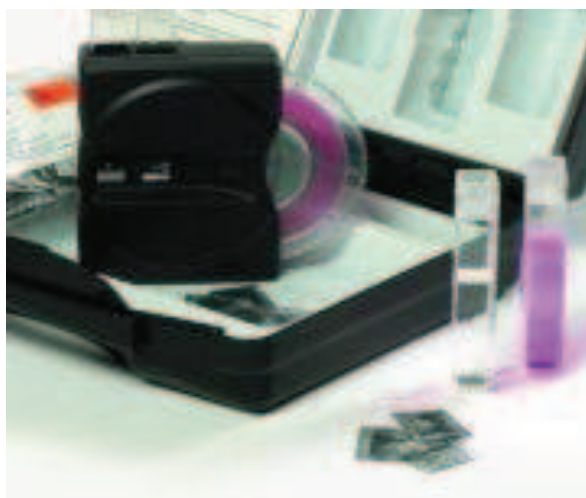
FIGURA 3.5.- EQUIPO DE MEDICIÓN DE CLORO RESIDUAL
