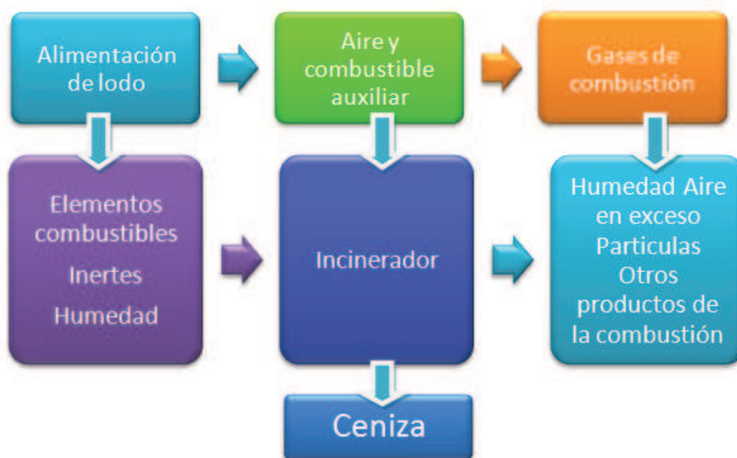
FIGURA 2.21 ELEMENTOS UTILIZADOS EN UN SISTEMA DE INCINERACIÓN
