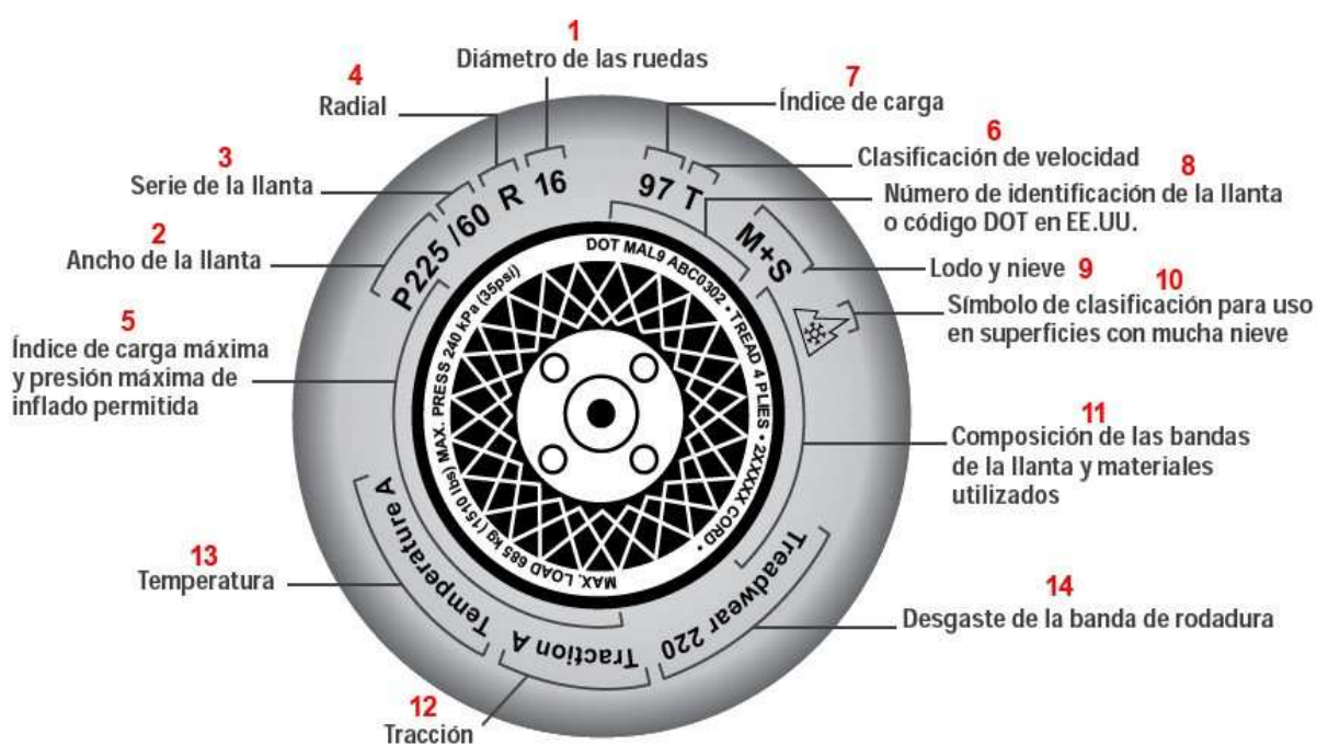
Figura 3. 42. Nomenclatura de los neumáticos
