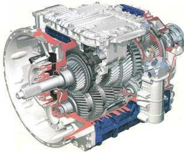
Figura 3. 27. Caja de velocidades (corte de noventa grados)
