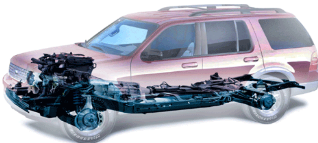
Figura 3. 20. Carrocería chasis por separado (vehículos 4x4)
