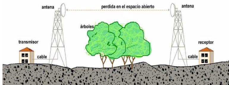
Figura 2.51 Trayectoria completa de transmisión entre el transmisor y el receptor. [83]
