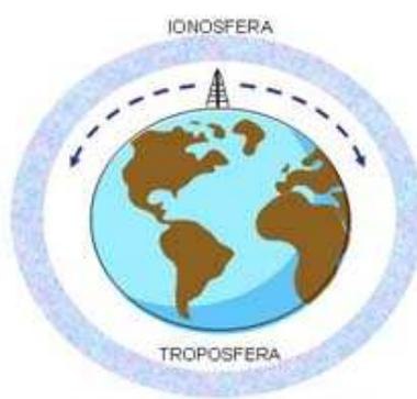
Figura 2.8 Propagación por onda terrestre. <sup>[29]</sup>
