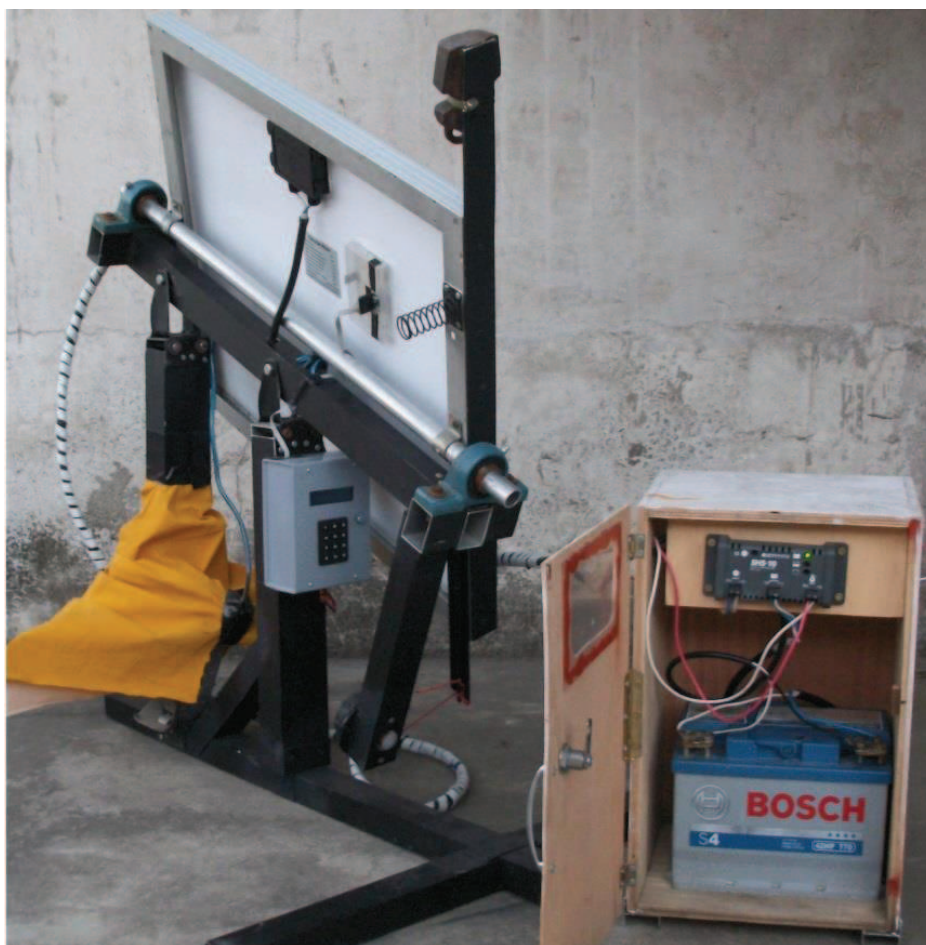
Figura 2.43. Sistema de seguimiento del Sol ensamblado completamente
