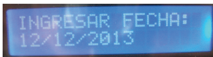
Figura 2.36. Ejemplo del Menu_fecha mostrado en el LCD
