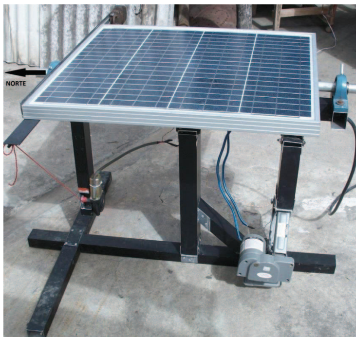
Figura 2.9. Estructura mecánica terminada
