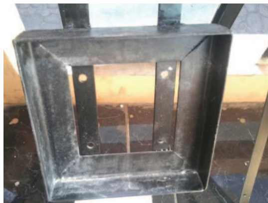
Figura 4. 2 Estructura de sujeción de la placa fuente de calor
