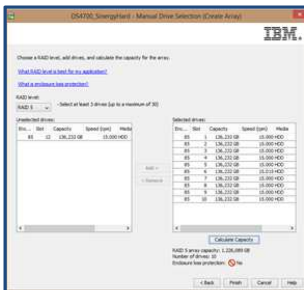
Figura 4.20 Creación del Raid 5
