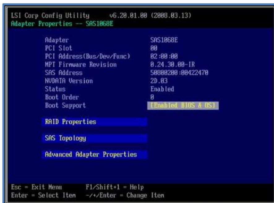
Figura 4.14 Opciones de configuración de la utilidad de configuración raid
