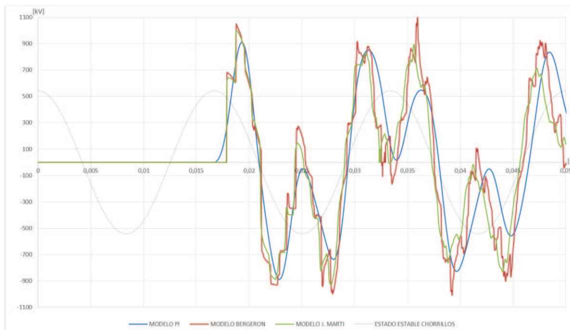
Figura4.25 Respuesta de simulación en energización de la Línea de Transmisión El Inga-Chorrillos del SNT de 500 kV con línea de transmisión de 350km, medición de la onda de voltaje Subestación Chorrillos.
