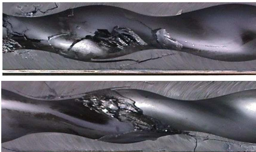
Los daños del estator polimérico se observan principalmente en el extremo de la descarga, ya que esta sección se encuentra sometida a mayores esfuerzos de fatiga.
