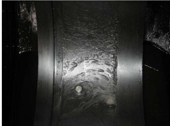
Con todos estos antecedentes, es necesario revisar el conjunto impulsor (eje-impulsores), los cuales presentan daños en algunos de sus componentes: álabes de impulsores, collarín, etc. Uno de estos daños se ilustra claramente en la figura 4.13.
