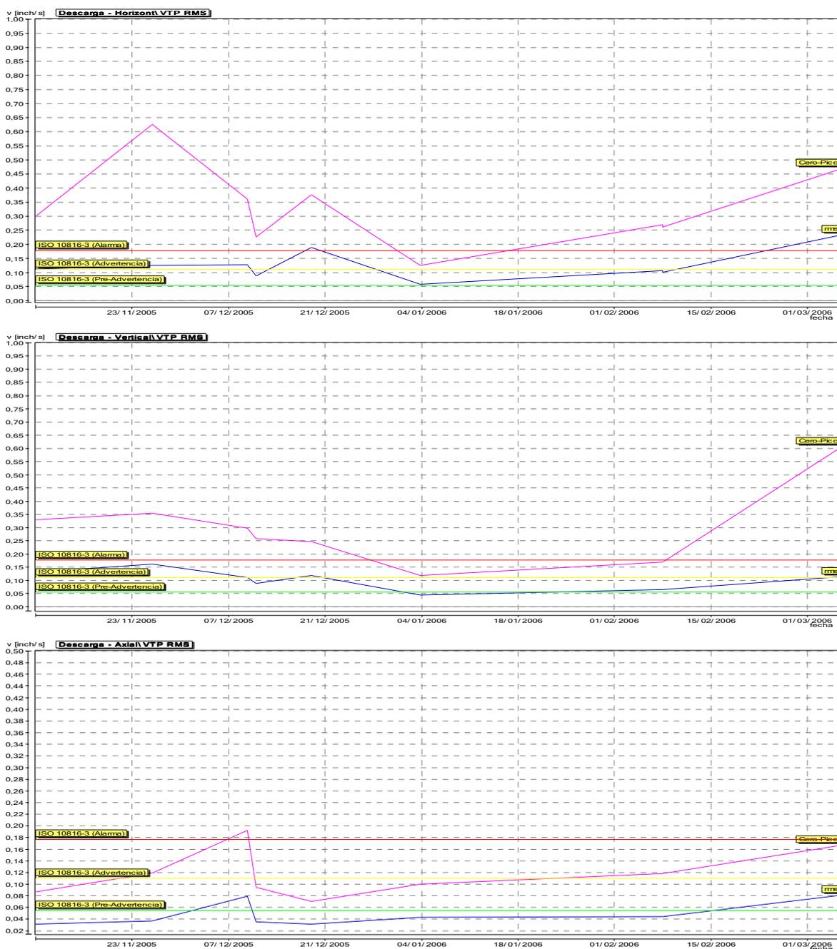
**FIGURA 4.25 TENDENCIA DE VELOCIDAD DE VIBRACIÓN LUEGO DE CAMBIO DE ESTATOR DE LA BOMBA “BOOSTER” DE CRUDO CF10-PU1-001B – LADO SUCCIÓN**
