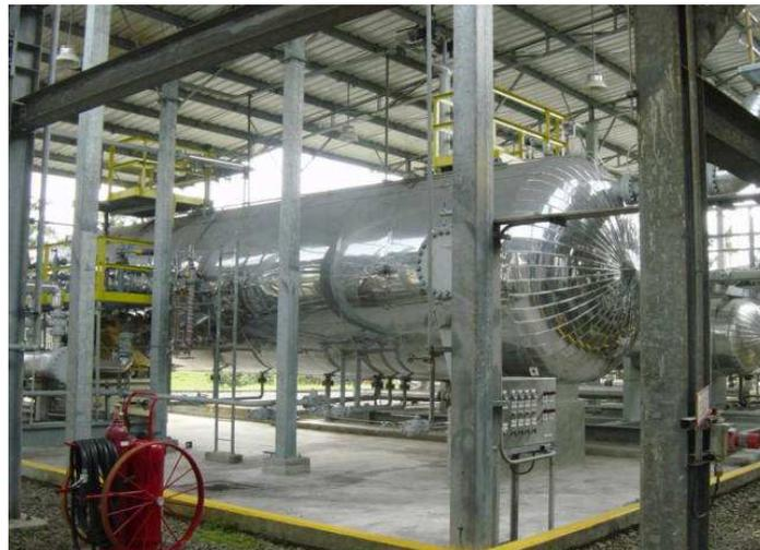
En el interior del equipo FWKO existen compartimientos donde se acumula y se distribuye el crudo hacia los Calentadores-Tratadores (Heater-Treaters), el agua sale al intercambiador y el gas hacia el Cabezal de Enfriamiento (Over Head Cooler).
