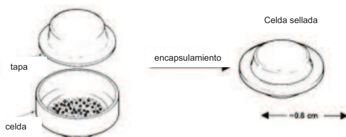
Figura 1.28. Celda para ensayo DSC antes y después del encapsulamiento (Universidad Oldenburg Carl von Ossietzky, 2006)
