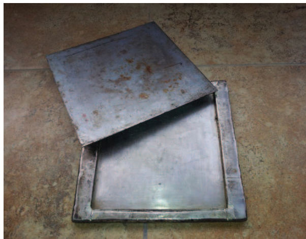
Figura 2.4. Molde tipo flash utilizado para la elaboración de probetas por moldeo a compresión
