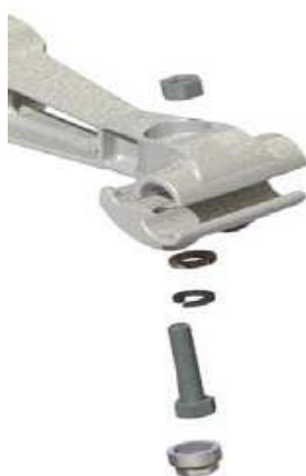
Figura 4.7. Sujeción mediante grapa abulonada
