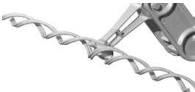
Figura 4.6. Sujeción mediante varillas preformadas
