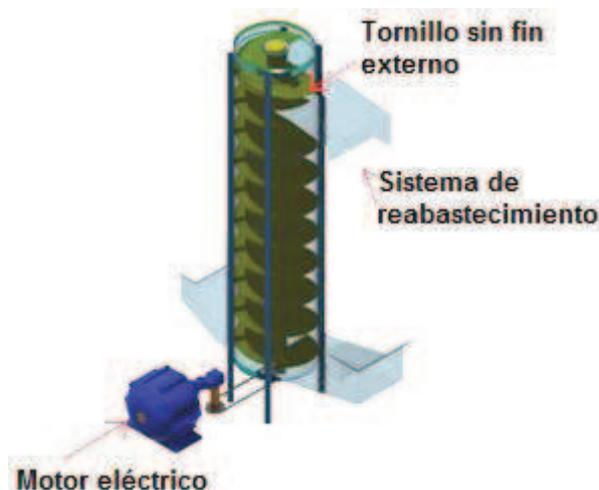
Figura 3- 14: Reabastecimiento mediante un tornillo sin fin externo.
