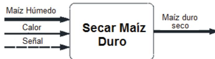
**Gráfico 3- 13:** Función global de la máquina secadora de maíz
