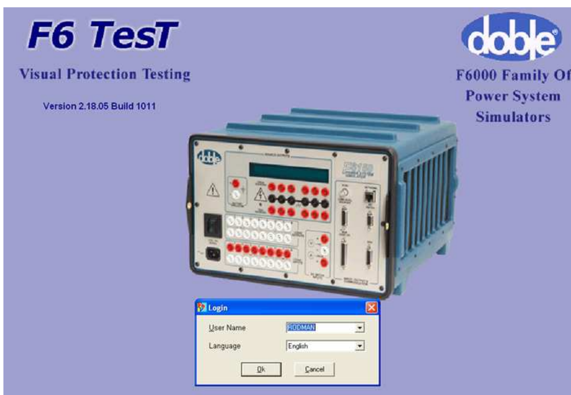
Fig.36 Equipo para la realización de pruebas del IED P442, Doble F6150.
