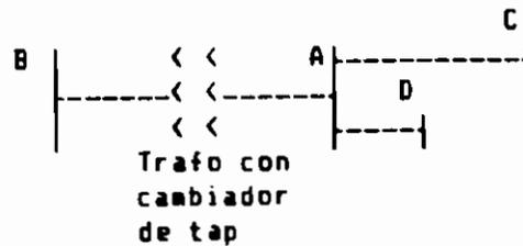
La barra A aunque tiene conexiones con otras barras solamente controla a la barra B mediante taps, en mayor grado, ya que el efecto se manifiesta en todo el sistema.
