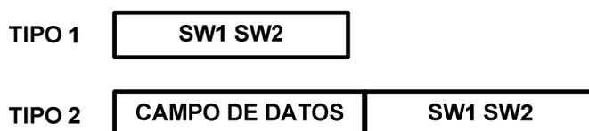
**Figura 1.8 Tipos de una respuesta APDU.**
