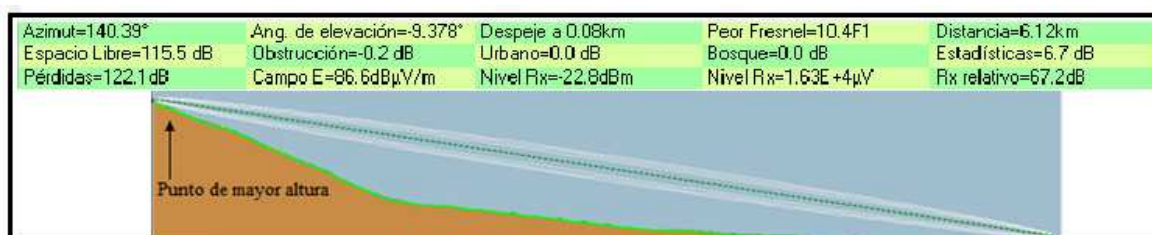
Figura 2.9: Cálculo de radioenlace usando Radio Mobile.
