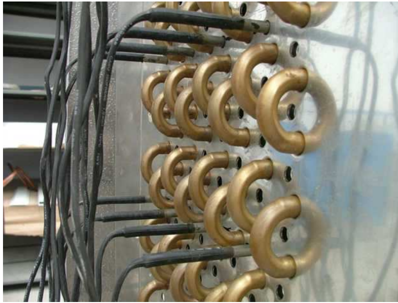
Figura N° 2.20 Descongelamiento por resistencias eléctricas en un evaporador marca COPELAND 16 .
