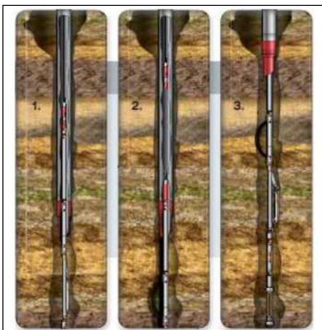
FIGURA 0.1 MÉTODO DE DESCUELGO O COMPACT DROP OFF (CDO)
