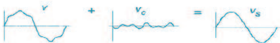
Figura 5.7 Compensación de forma de onda de un filtro activo serie
