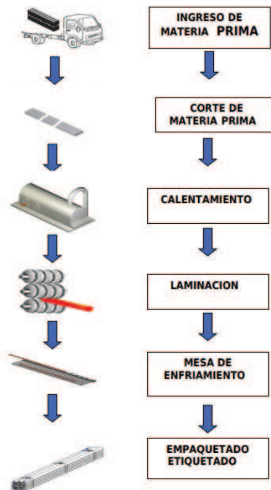
Figura 1.11 Proceso de Producción Planta Lasso NOVACERO S.A.
