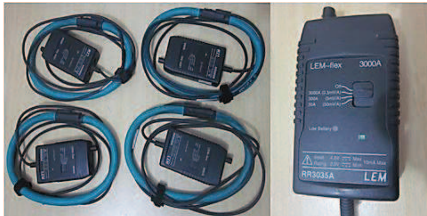
Figura 3.5 Pinzas de corriente usadas en las mediciones
