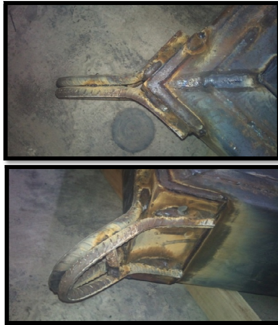
Figura 5-4: Ángulos y ganchos, soldados con electrodos 70/18
