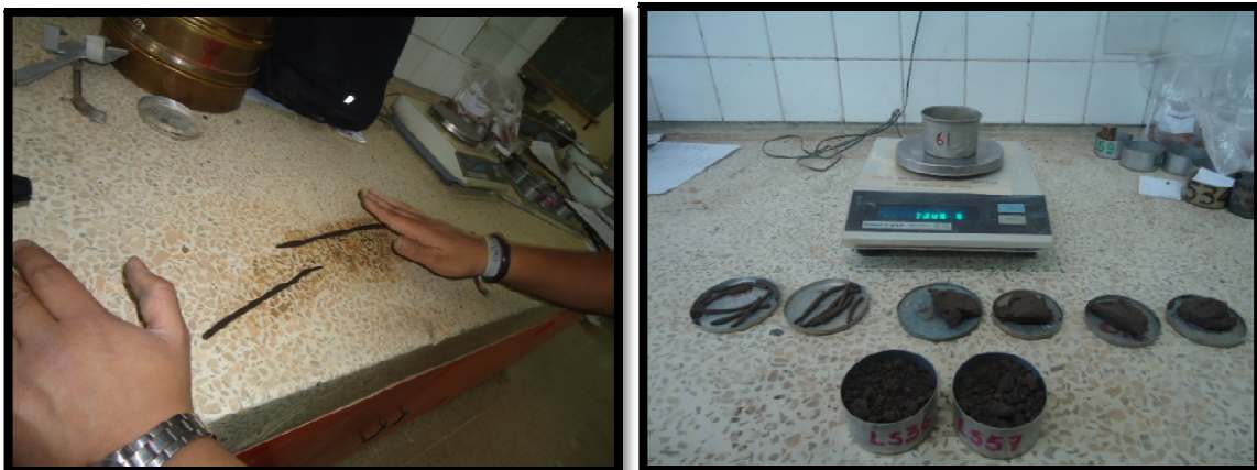
Figura 3-7: Cilindros de Material de 3.00 mm aproximadamente
