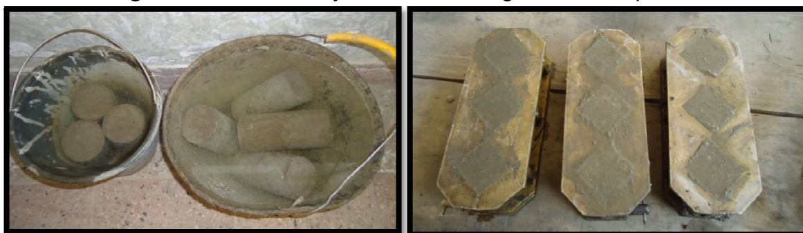
Figura 5-36: Cilindros y cubos de hormigón de enchape
