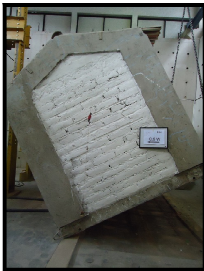
Figura 6-10: Carga aplicada del 60% del peso total (3.78 t) Y-Y, P4.
