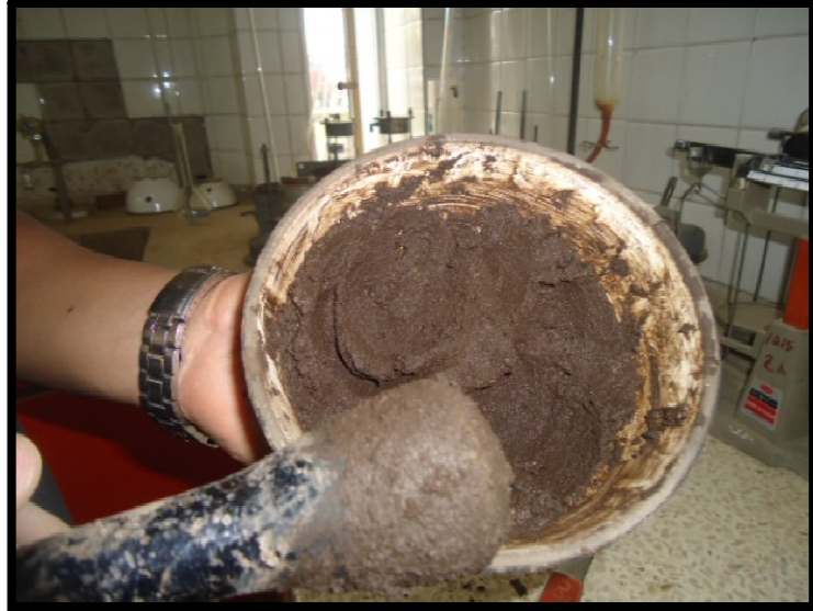
Figura 3-6: Mezcla de barro y agua con suficiente Plasticidad
