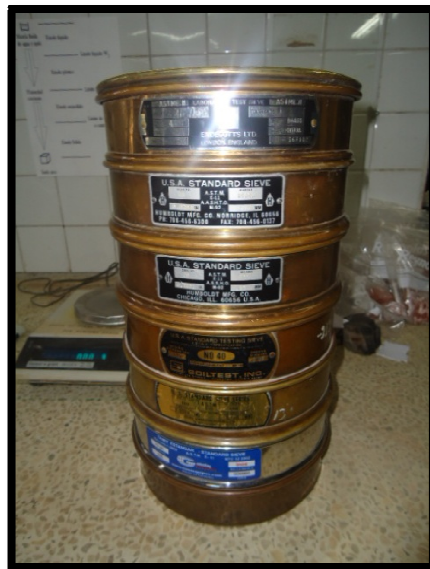
Figura 3-3: Tamices apilados según la Norma ASTM-D-421
