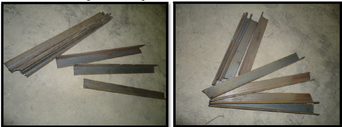
Figura 5-6: Ángulos de acero LX40X40X5
