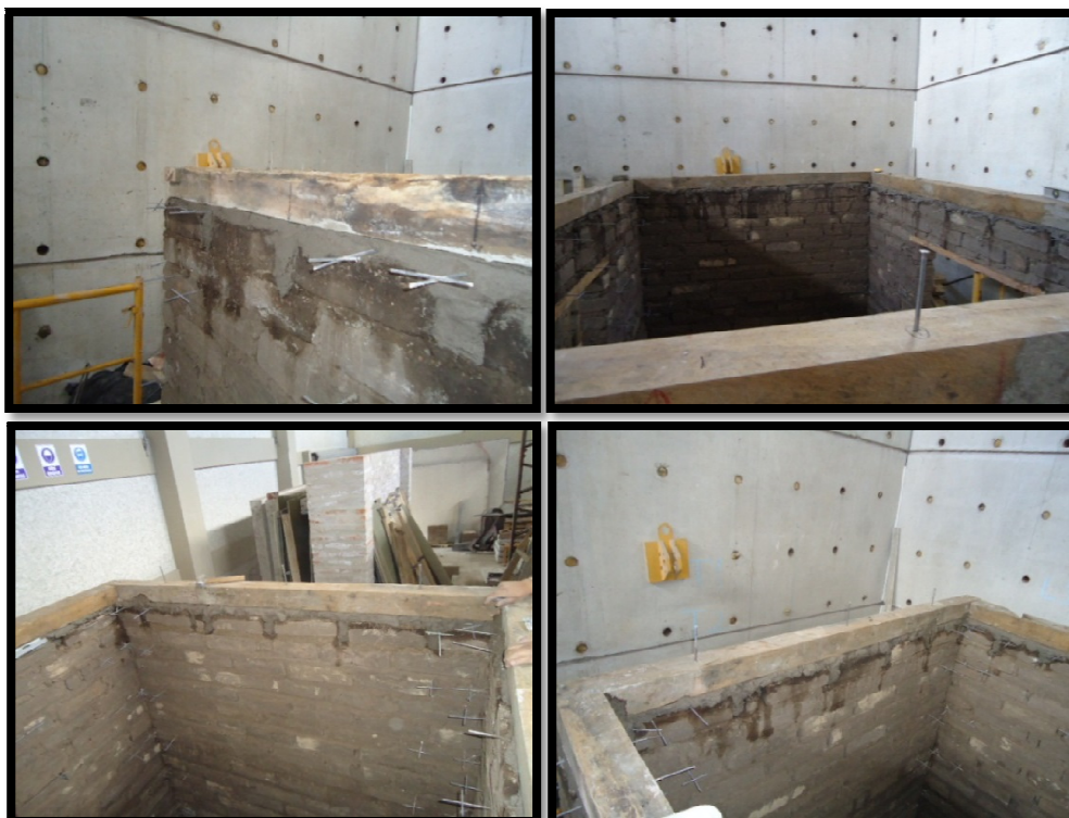
Figura 5-25: Ubicación de las vigas soleras sobre la última hilera del prototipo
