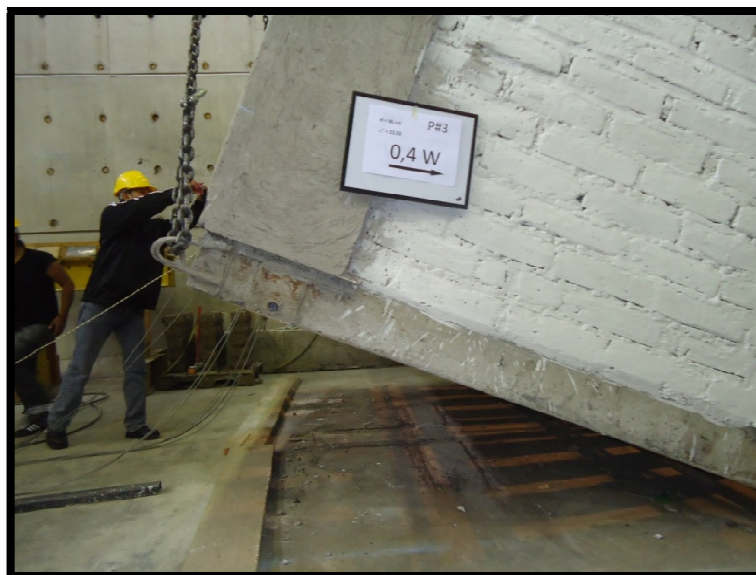
Figura 6-6: Carga aplicada de 40% del peso total (2.5 Ton) Y-Y, P3
