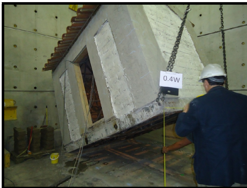
Figura 6-4: Carga aplicada de 40% del peso total (2.5 Ton) X-X, P1.
