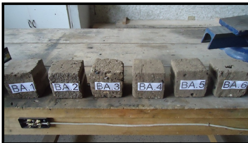
Figura 8-1: Cubos tallados de un bloque de tierra cruda
