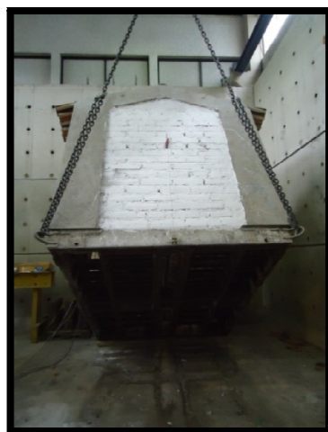
Figura 6-8: Carga aplicada de 60% del peso total (3.78 Ton)X-X, P1
