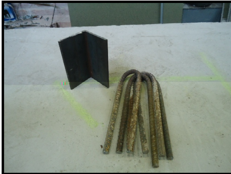
Figura 5-3: Varillas de acero corrugado y ángulos de acero
