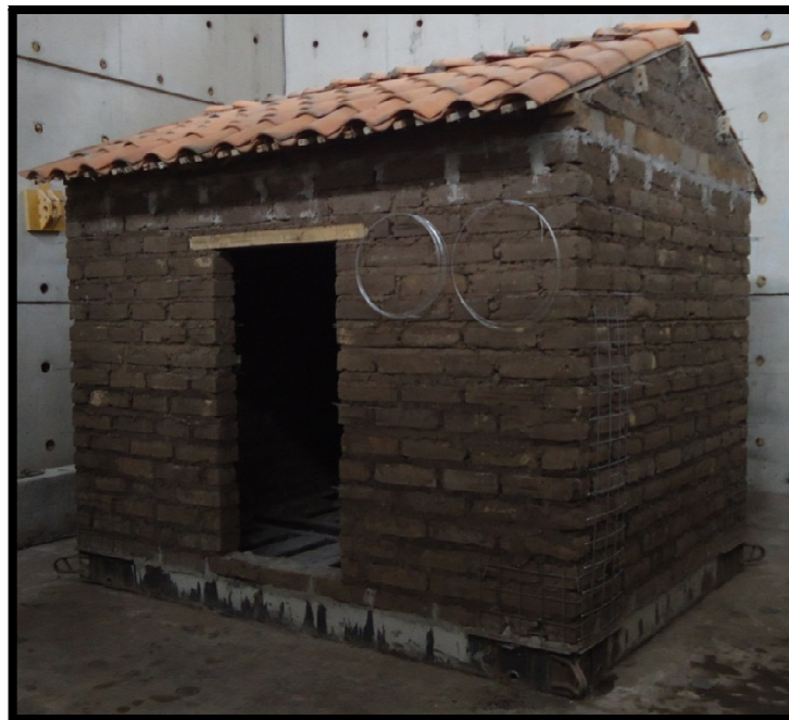
Figura 5-32: Prototipo sin reforzamiento
