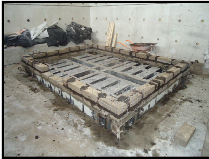
Figura 5-10: Primera hilera de bloques de adobe sobre la plataforma de acero
