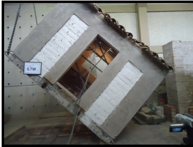
Figura 6-7: Carga aplicada de 70% del peso total (4.40 Ton)X-X, P2
