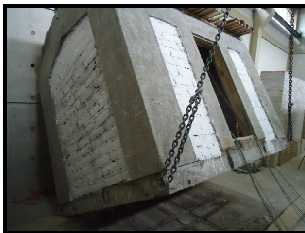
Figura 6-9: Carga aplicada 60% del peso total (3.78 Ton) Y-Y, P3.
