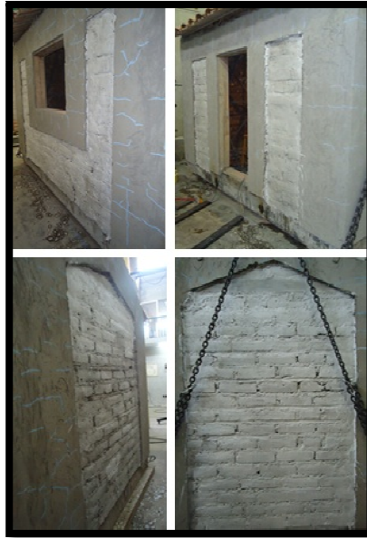
Figura 7-3: Preparación del prototipo para las distintas pruebas programadas
