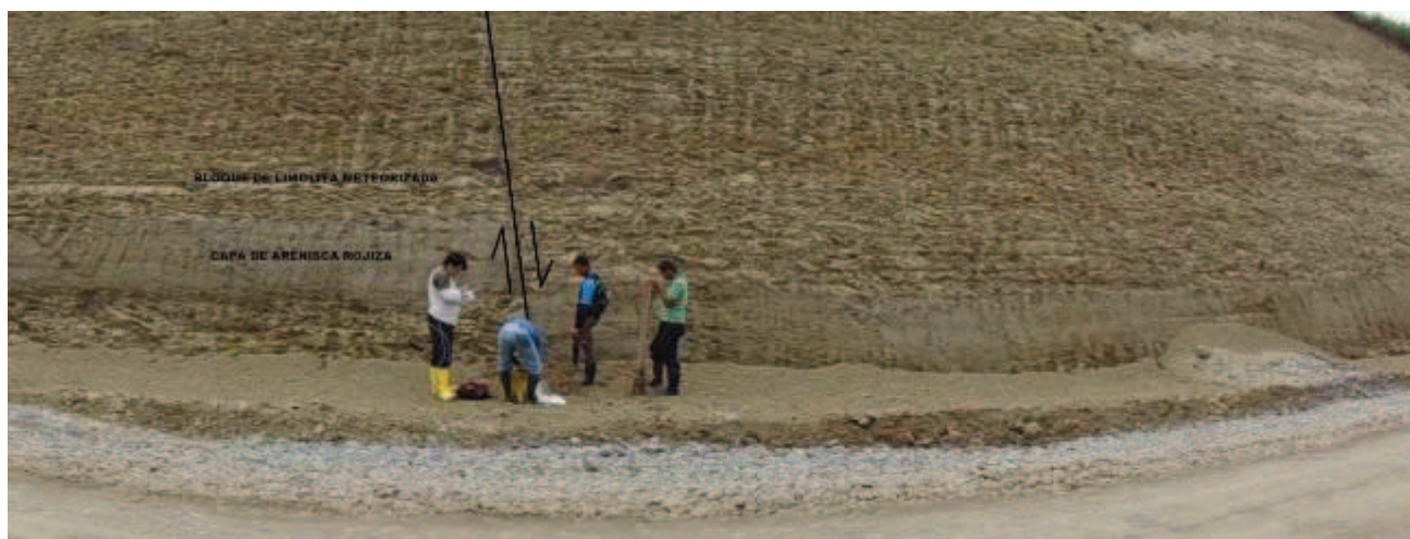
Fotografía 3.4: Afloramiento de la columna estratigráfica N°1, visible el detalle del fallamiento normal y las capas de arenisca con tonalidad rojiza entre las limolitas meteorizadas.
