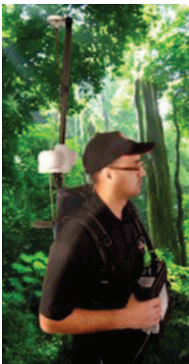
Fotografía 4.5: Magnetómetro GEM GSM-19, equipo armado, consola y bobina.
