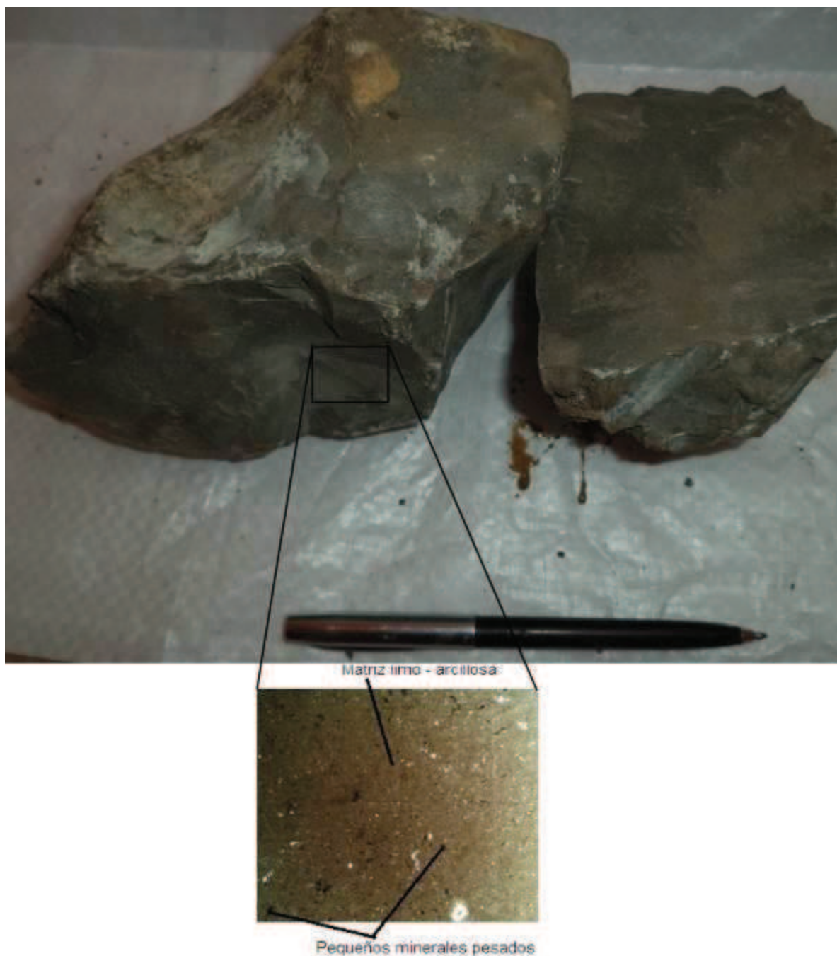
Fotografía 3.14: Limolita que abarca la mayor parte de la zona de estudio (Fm. Onzole), en su sección delgada se aprecian solo arcillas y leves incrustaciones de óxidos, hay pocos microfósiles.
