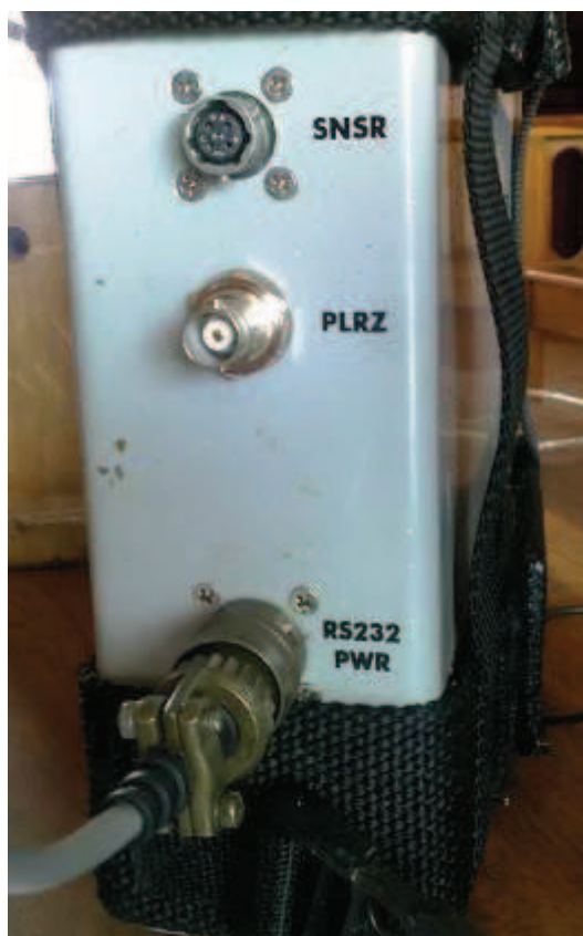
Fotografía 4.2: Magnetómetro GEM GSM-19, vista lateral.
