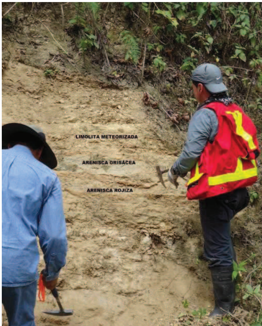
Fotografía 3.6: fotografía del afloramiento corresponde a la columna estratigráfica N°2, visible la intercalación de las areniscas rojizas y grises con el bloque de limolitas meteorizadas fuertemente.
