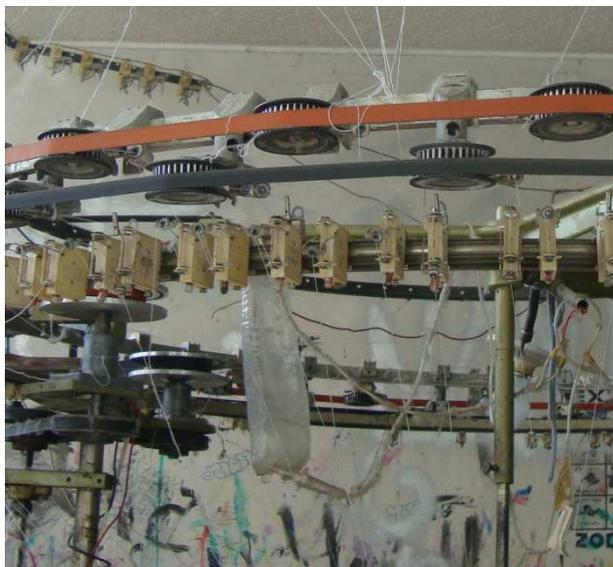
*Figura 2.13* Sistema de lubricación
