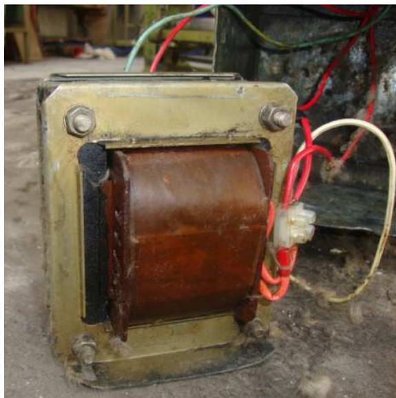
*Figura 2. 27* Transformador de voltaje
