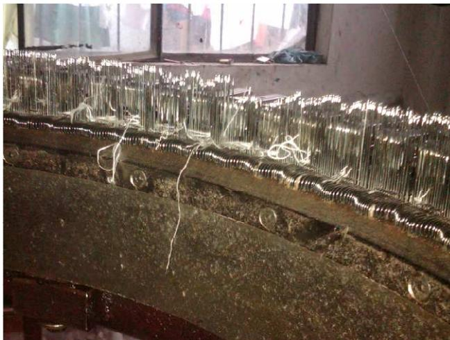
*Figura 2.4* Agujas de la máquina circular
