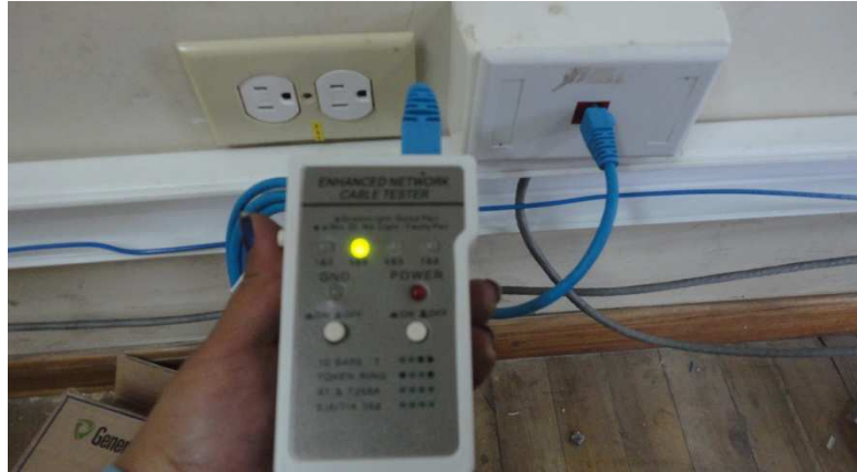
Figura 3-5: Comprobación de continuidad en el punto de red
