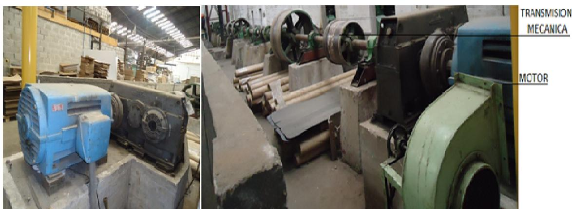
**Figura 2.6 Transmisión mecánica.**
