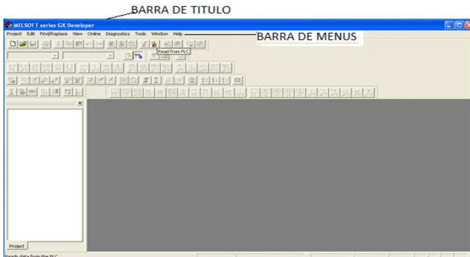
**Figura 2.15 Entorno de programación del Software Melsoft Gx Developer.**
