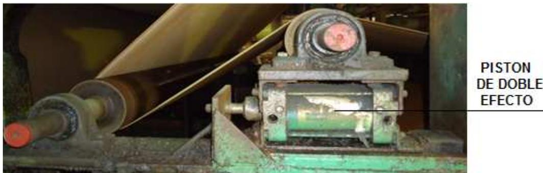
**Figura 2.9 Desplazamiento con cilindro de doble efecto.**
