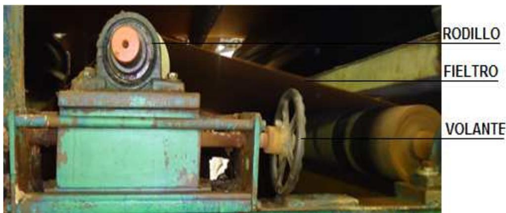
Figura 2.8 Sistema de desplazamiento manual.
