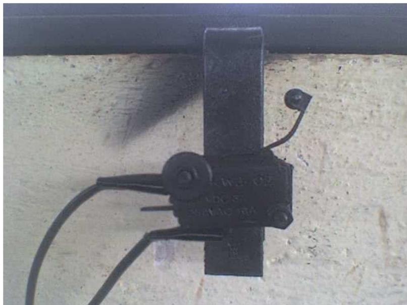
**Figura 1.10** Montaje de finales de carrera
