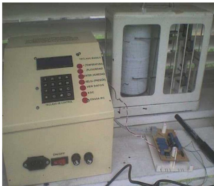
**Figura 4.1** Sistema electrónico y termohigrógrafo
