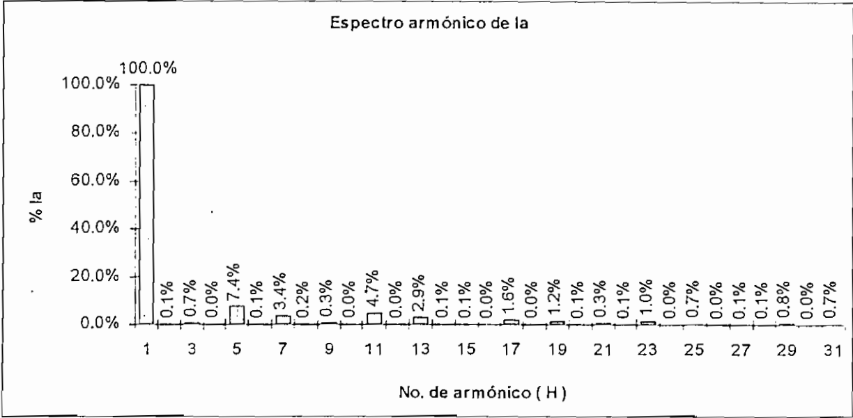
Figura 6.13 Espectro armónico de la corriente para la demanda máxima sin en banco de capacitores.
