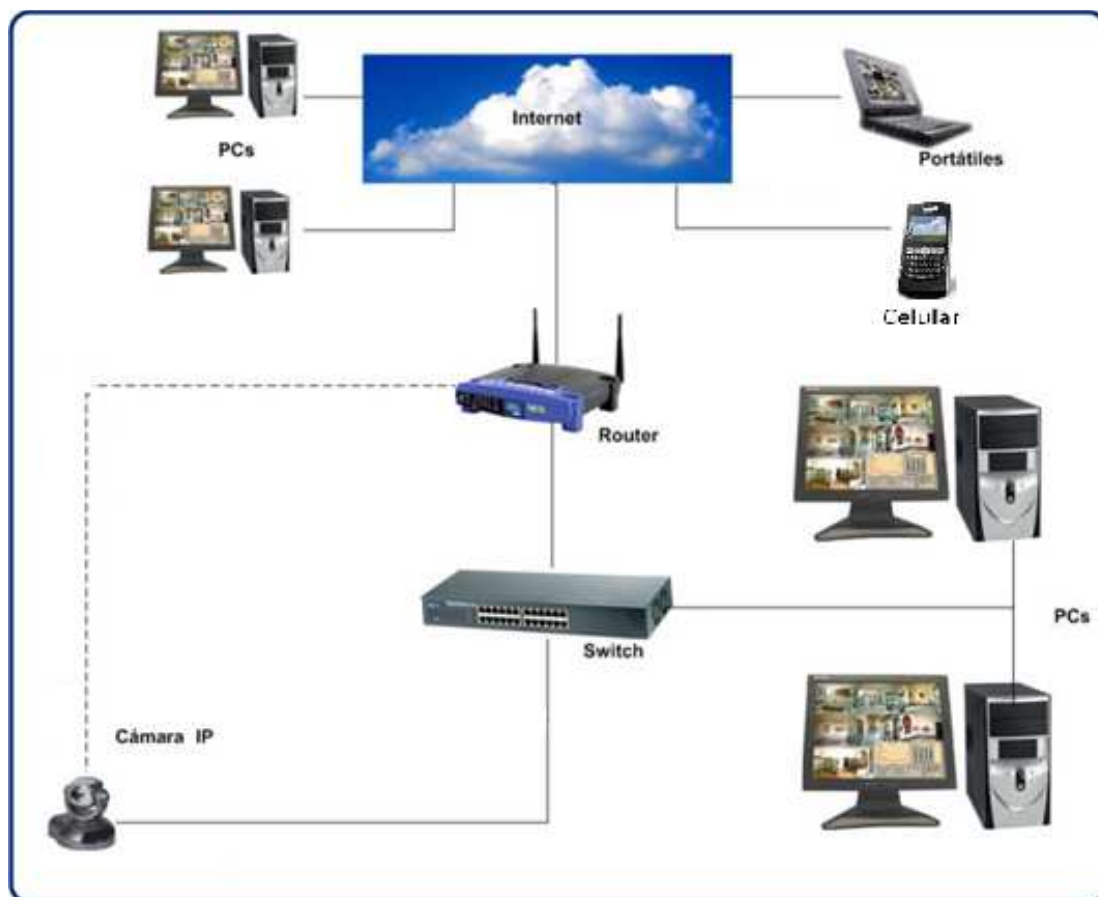
Figura1.1: Esquema de acceso a la Cámara IP.
