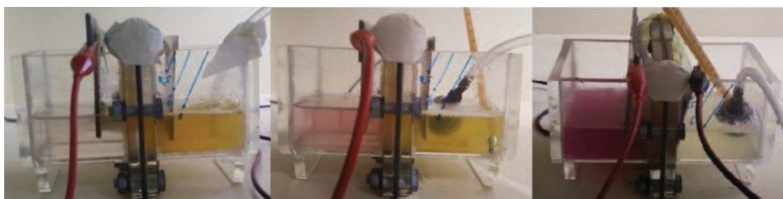
Figura 3.24. Desarrollo del proceso de electrodeposición. (De izquierda a derecha: t=0 \text{ h} , t=2 \text{ h} , t=5 \text{ h} ). (Lado izquierdo de celda: Solución \text{H}_2\text{SO}_4 . Lado derecho de celda: Solución lixiviada)
