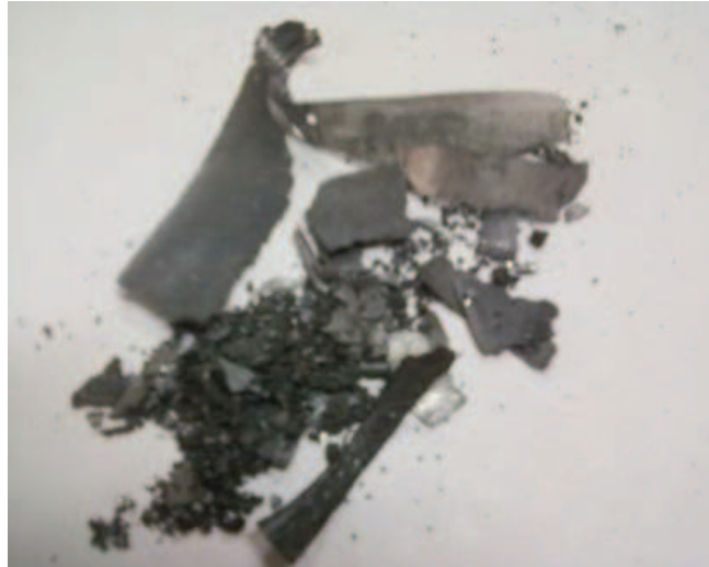
Figura 3.19. Deposito catódico obtenido a 1\ 150\ \text{A/m}^2 (52,08 % Zn; 20,50 % O; 12,12 % Cl)
