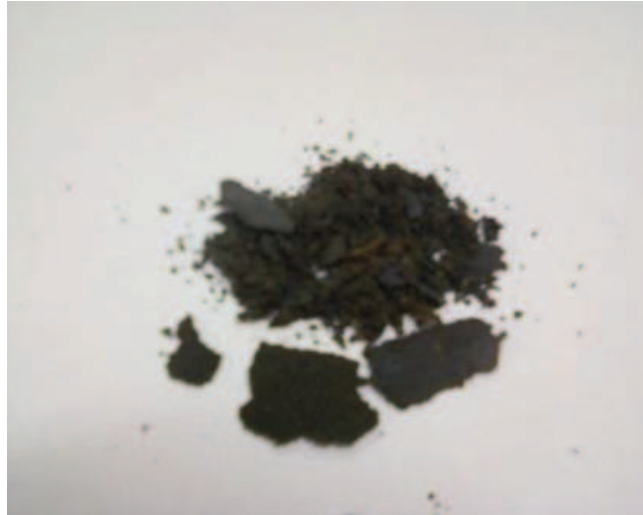
Figura 3.17. Deposito catódico obtenido a 2\ 000\ \text{A/m}^2 (28,36 % Zn; 28,36 % O, 18,55 % Cl)
