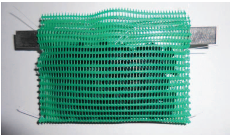
Figura 2.6. Cátodo para electrodeposición conformado por la placa de acero y el carbón activado en la funda de malla plástica
