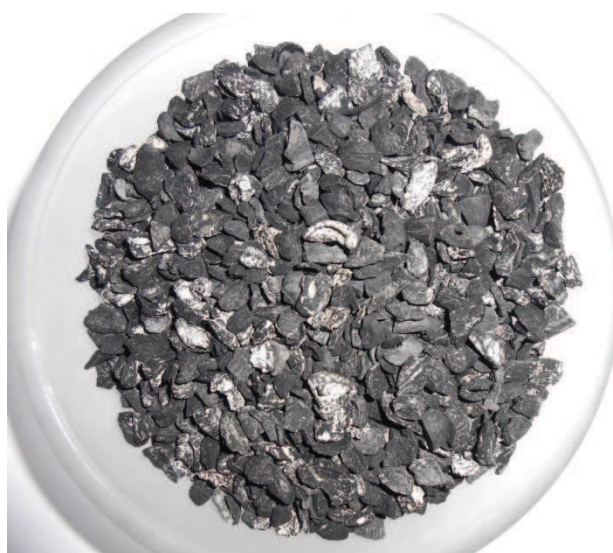
Figura 3.7. Carbón activado impregnado con nitrato de plata (2,4 – 4,7 mm)
