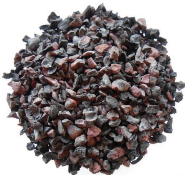
Figura 3.12. Carbón activado con cobre electrodepositado (2,4 – 4,7 mm)
