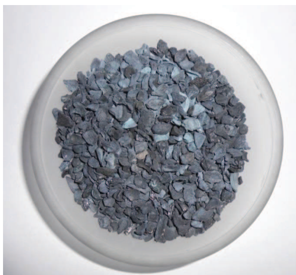
Figura 3.3. Carbón activado impregnado con nitrato cúprico (2,4 – 4,7 mm)
