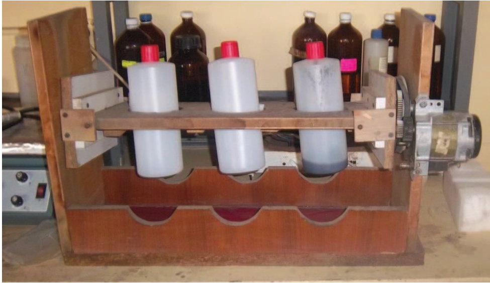
Figura 2.13. Agitador rotario, según especificaciones del método EPA 1311, utilizado para la lixiviación del suelo antes y después del tratamiento electrocinético
